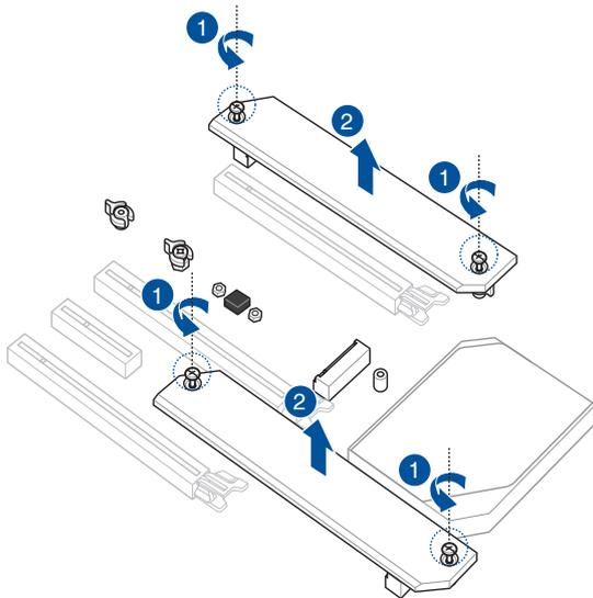
3. 安装您的 M.2 至 M.2 插槽。安装不同长度之 M.2 之间的步骤可能有所不同，请参考以下不同类型与其安装步骤：
