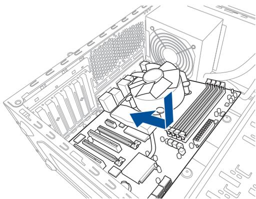
2. 将 9 个螺丝放入主板上的螺丝孔并旋转锁紧，以确保将主板锁至机箱。
